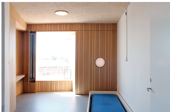
Niche i vinduet er optimeret, sådan at der kommer sollys ind i syd- og vestvendte sengestuer så tidligt som muligt. Samtidigt skaber nichen flere solskinstimer. Den drejbare 1:1 mockup repræsenterer en lille sengestue på 15 m 2 på Ny Psykiatri Bispebjerg. Foto: Carlo Volf
